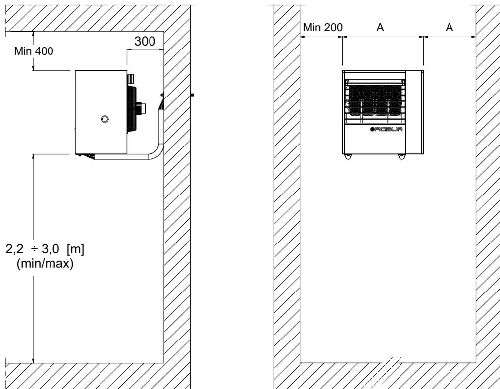
Distanze di rispetto: spazio minimo utile per l'installazione.
